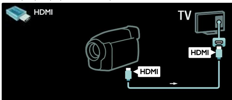
Sinon, utilisez un câble HDMI ou la vidéo composantes et le câble audio (YPbPr et Audio G/D) pour relier le caméscope à l'arrière du téléviseur.
