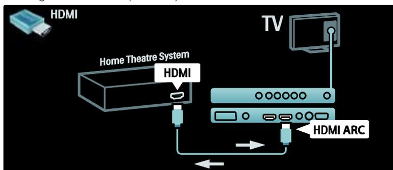
La connexion HDMI ARC vous permet d'utiliser Philips EasyLink pour transmettre directement le signal audio du téléviseur à un appareil audio connecté, sans ajouter de câble audio numérique.
