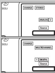
**7** Le format du signal (stéréo/multicanaux) sera analysé automatiquement et indiqué sur l'écran d'affichage :
