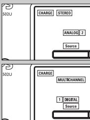
**7** Das Signalformat (Stereo/mehrkanalig) wird automatisch analysiert und im Display angezeigt:
