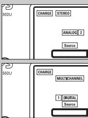
**7** Het signaalformaat (stereo / meerkanaals) wordt automatisch geanalyseerd en weergegeven in het display:
