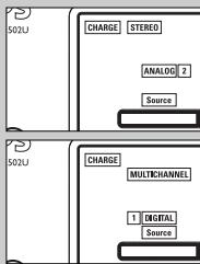
**7** Signalformatet (stereo/ multikanal) analyseras automatiskt och anges på displaypanelen:
