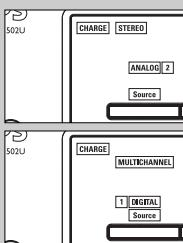
**7** O formato do sinal (estéreo / multi-canais) será analisado automaticamente e indicado no visor:
