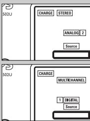
**7** Il formato del segnale (stereo/multicanale) verrà analizzato automaticamente ed indicato sul pannello del display:
