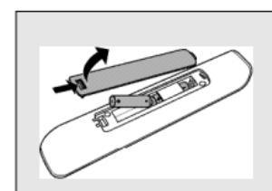
Note:Hvis LED'en blinker fire gange efter hvert tryk på en knap, angiver fjernbetjeningen, at dens batterier er ved at blive opbrugte. Udskift de gamle batterier med to nye batterier af AAA typen.
