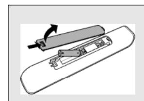
Merk: Hvis lysdioden blinker fire ganger etter hver gang du trykker på en knapp, fjernkontrollen viser at batteriene nesten er utladet. Skift ut de gamle batteriene med to nye AAA-batterier.
