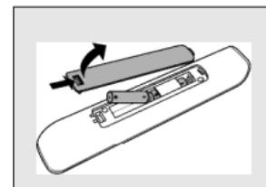
*Let op: Als de LED vier keer knippert, telkens als een toets ingedrukt wordt, geeft de afstandsbediening aan dat de batterijen bijna leeg zijn. Vervang de oude batterijen door twee nieuwe, type AAA.*
