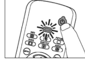
**4** Beim Abschalten des Fernsehgeräts (Standby - Bereitschaft) lassen Sie die Standby-taste der SRU 5010 sofort los.
