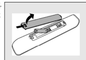
OBS: Om lampan blinker fyra gånger varje gång en knapp trycks ner, fjärrkontrollen anger att batterierna börjar ta slut. Byt ut de gamla batterierna mot två nya av AAA-typ.
